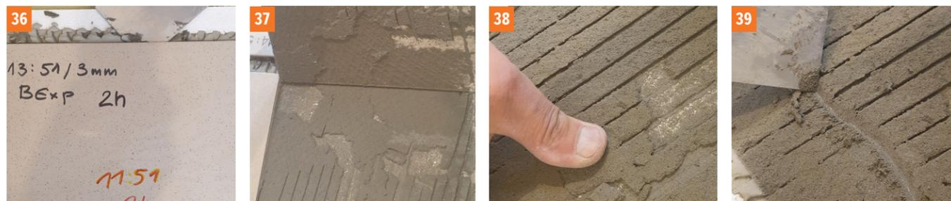
Fotos 36, 37, 38, 39 Schnell abbindender Kleber Nr. 2 (Klasse „F“). Nach dem Anheben der Fliese ist deutlich sichtbar, dass der Bruch in der Klebeschicht stattgefunden hat. Der Kleber ist nur teilweise abgehoben und lässt sich leicht mit dem Finger oder einem Werkzeug verreiben.
