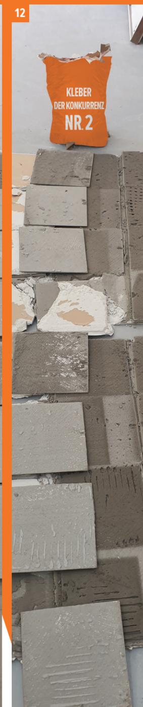
Fotos 10, 11, 12 Ergebnisse der Abreißversuche mit ausgewählten Klebern nach Abb. 1. Neben dem Abreißverhalten ist auch auf die Verfärbung des Klebers unter der Fliese zu achten. Sie gibt Aufschluss über den Feuchtigkeitsverlust der Klebmörtel und die Zunahme der Festigkeit sowie darüber, wann mit dem Verfugen von Keramikbelägen begonnen werden kann.
