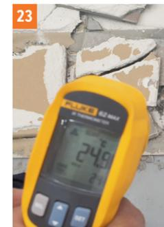
Fotos 22, 23 Geoflex Express. Die Temperatur der Fliesenoberfläche innerhalb von 5,5 Stunden nach dem Abbinden war stabil und überstieg bei der 3 mm Schicht nicht 23,2°C und bei der 15 mm Schicht nicht 24,9°C, d.h. sie war maximal 4,7°C höher als die Umgebungstemperatur (Hydratationswärme). Dies zeugt von einem stabilen Verlauf der Hydratationsreaktion.
