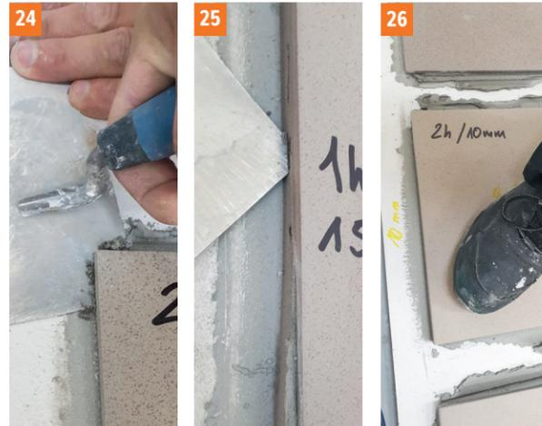
Fotos 24, 25 Geoflex Express. Mit erheblichem Kraftaufwand ist es möglich, die Kelle in die Klebemörtelschicht zu pressen, unabhängig davon, ob diese 3 mm oder 15 mm dick ist. Foto 26 Unabhängig von der Dicke der Mörtelschicht verursacht ein plötzliches Betreten der Fliese und das Drehen des Fußes kein Absinken oder Bewegungen der Fliese.
